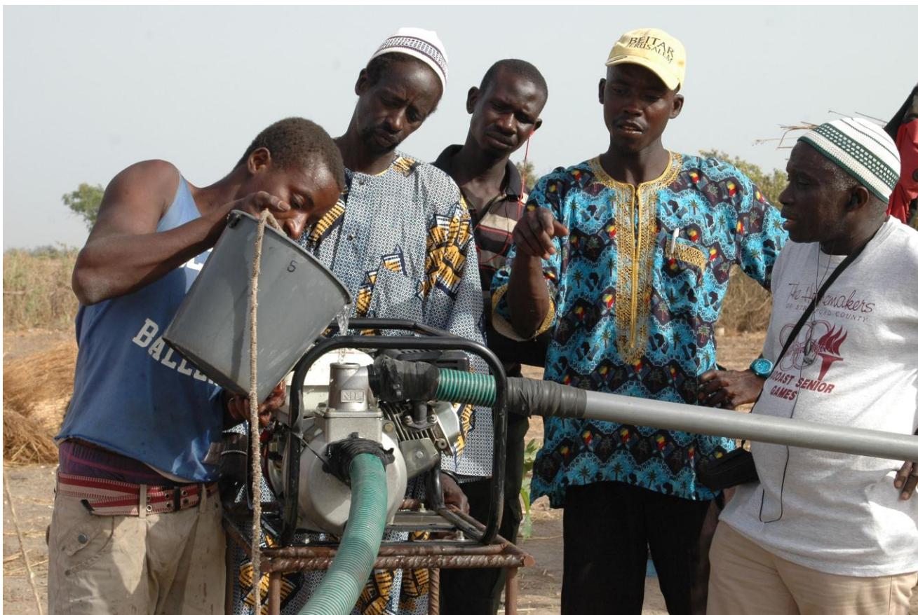
Der hældes vand i en pumpe for at sætte den i gang, så vandet fra en brønd kan overrisle nogle marker (foto: ASPSP)
